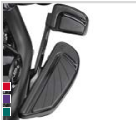
E. AIRFLOW FAHRERTRITTBRETTER-KIT – SCHWARZGLÄNZEND (ABGEBILDET MIT GRÖßER AIRFLOW BREMSPEDALAUFLEGE)
