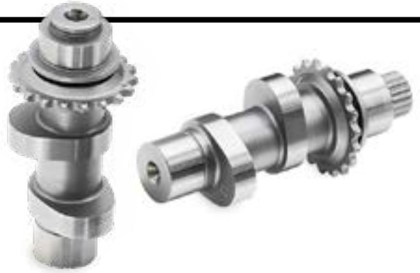
Twin Cam 103CI Serie im Vergleich zu 103CI Stage II mit SE-255 Nockenwelle
