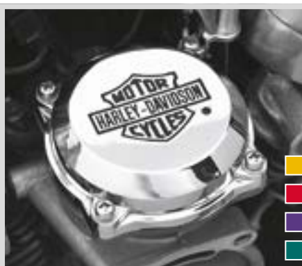
J. CV-VERGASERDECKEL – BAR & SHIELD
