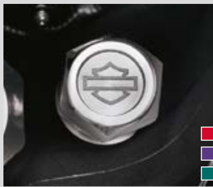
D. GETRIEBEÖL-PEILSTAB – (37103-08 ABGEBILDET)
