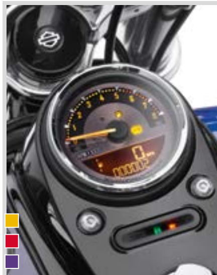
B. DIGITALER TACHOMETER/ANALOGER DREHZAHLMESSER – 4" ALUMINIUMGUSS-ZIFFERBLATT
