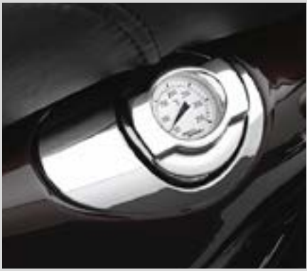
E. ÖLPEILSTAB MIT TEMPERATURANZEIGE – SPORTSTER AB '04
